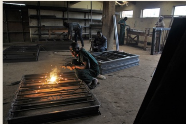
Herstellen von Metallfenstern in einem Ausbildungsbetrieb
